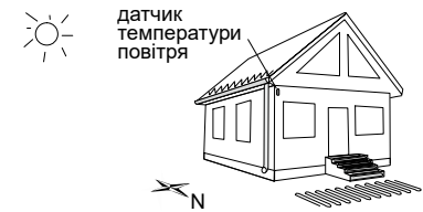
Рисунок 1. Монтаж датчика температури повітря
